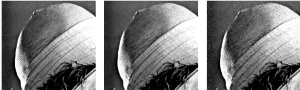
FIGURA 1. De izquierda a derecha: original (Lena), comprimida sin ruido (1 BPP) y comprimida con ruido (1 BPP, \sigma = 7 ). El rango dinámico fue saturado para una mejor visualización.
