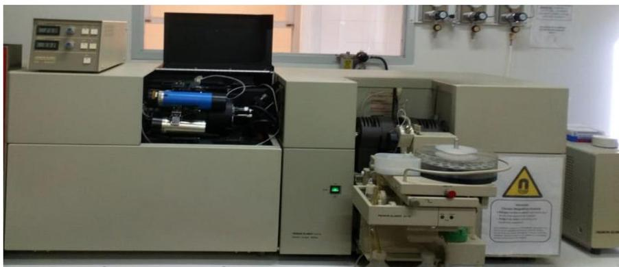
**Figura 2.1.1** Espectrómetro de absorción atómica Perkin Elmer 5100 PC utilizado en la presente Tesis.
